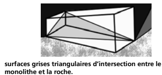
Robert LATOUR d'AFFAURE, architecte, «Ispilu Ainguratu» («Miroir Ancré»), Paseo Nuevo, Saint-Sébastien, 2002. Croquis et plan masse expliquant les zones de contact entre le prisme architectural et la roche de la montagne. Coupe montrant que le «Tunnel de Lumière» traverse l'espace intérieur (face encastrée).
